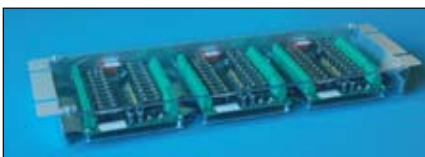
Tre stycken avsäkringskort med 10 utgångar (10UT) monterade i 19R, kapsling för 19" montage.
