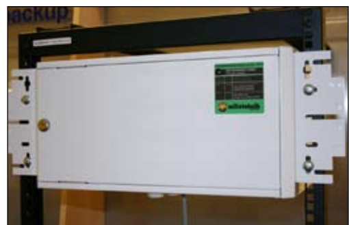
ECO XM monterad i 19" stativ med medföljande 19" vinklar.
