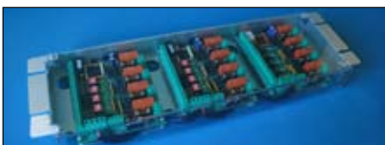
Tre stycken slingövervakningskort för övervakning av larmdon monterade i 19R, kapsling för 19" montage
