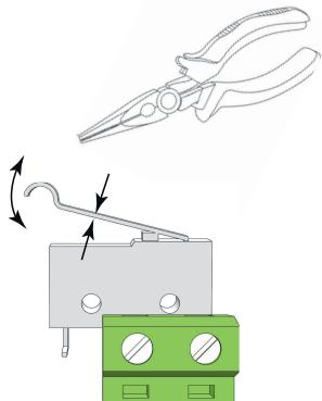
Sabotagekontakten hävarm skall vid stängd skåpdörr vara i slutet läge (stängd). Går larm ("tamper alarm" / larm till undercentral) kan hävarmen behöva justeras.
