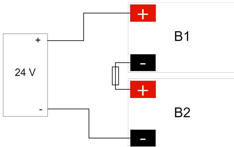
Anslut batterikablage på rätt poler. Vid felkoppling kan utrustning skadas.
