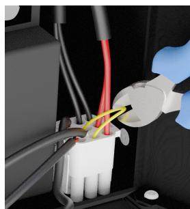
Bilden visar kabelanslutning från batteribackupen som möter kablar från batteribox och kabel som skall klippas i batteribackup för att bilda en slinga för sabotagekontakten.
