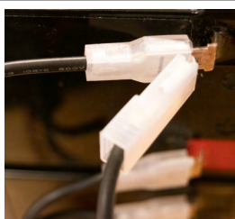
Kabel 2 skall kopplas på batteri med dubbelstift, (som sitter på kabel 1).
